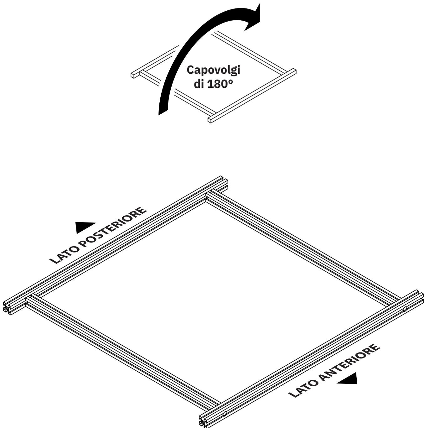
Capovolgi il gruppo del telaio di base per accedere al lato inferiore delle barre X e delle barre Y.
