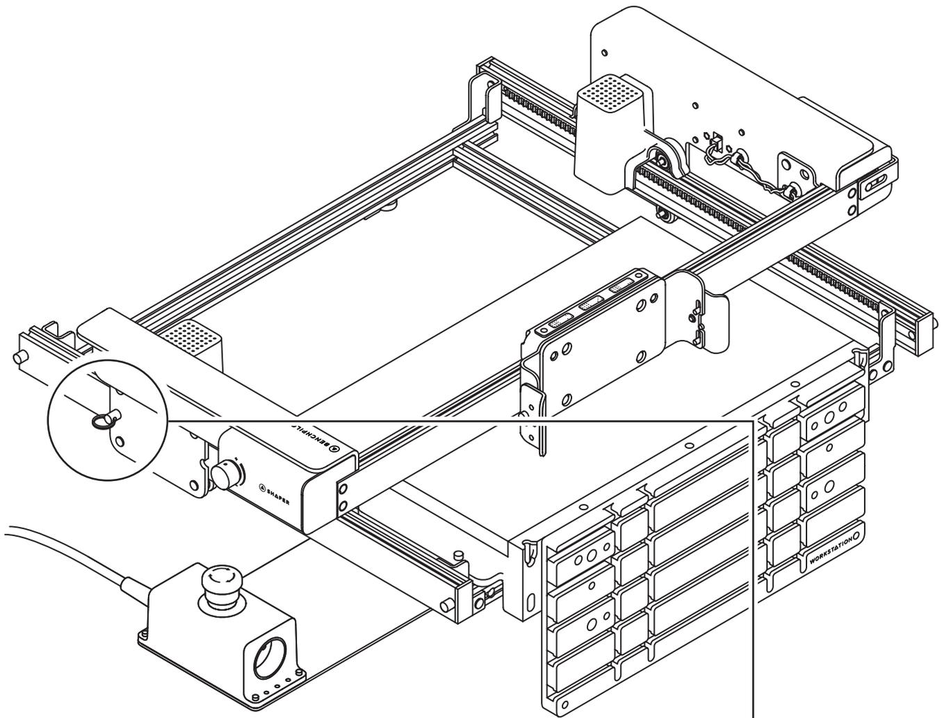
Rimuovi i perni di bloccaggio dai bracci sinistro e destro per consentire alla barra trasversale di muoversi liberamente avanti e indietro. Reinstalla sempre i perni di bloccaggio quando trasporti o riponi BenchPilot, poiché servono a mantenere i bracci fissi, evitando danni o infortuni durante il trasporto.
