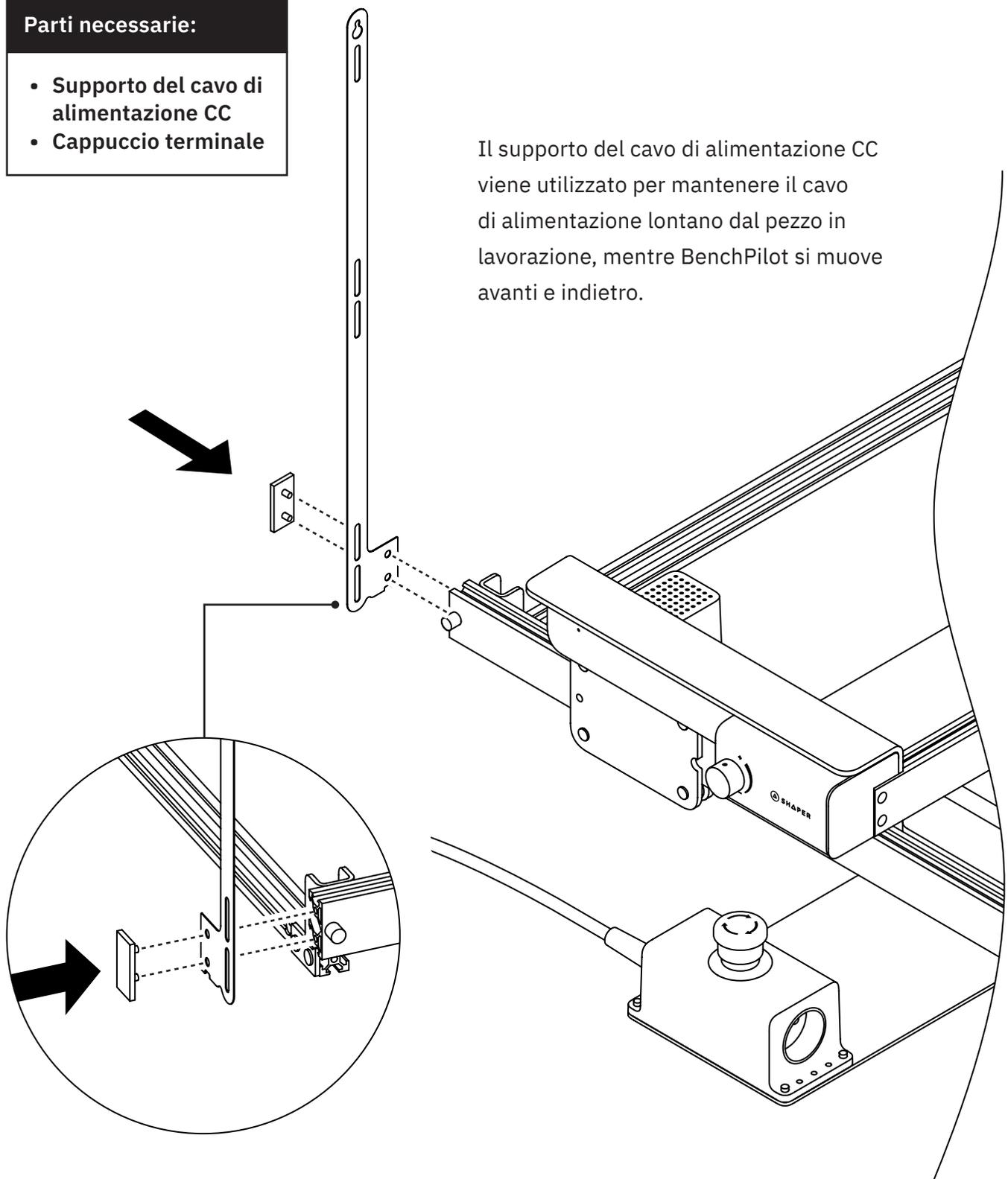
Installa il supporto del cavo di alimentazione CC posizionandolo tra il cappuccio terminale e il braccio sinistro. Premi con forza il cappuccio terminale sull'estremità del braccio sinistro per fissare il supporto del cavo di alimentazione CC in posizione.
