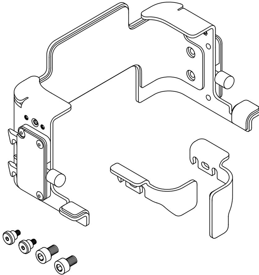
Prima di procedere al prossimo passaggio di montaggio, individua il supporto di Origin, la staffa laterale sinistra, la staffa laterale destra, le viti C (2x) e le viti E (2x).
