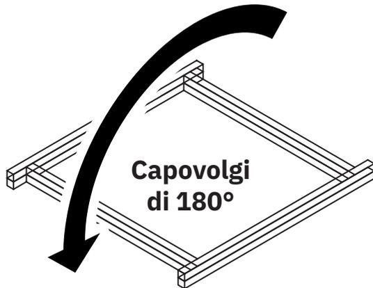
Capovolgi il gruppo del telaio di base verso l'alto, in modo che i piedini poggino sul piano del banco di lavoro. Verifica che la disposizione dei piedini corrisponda approssimativamente all'illustrazione sottostante, osservando il gruppo del telaio di base dall'alto.
