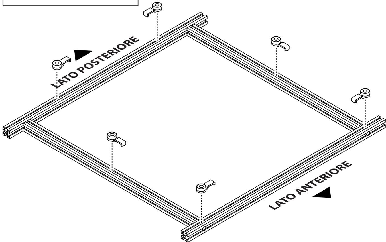
Installa i piedini inserendoli nella guida a T nella parte inferiore delle barre X e Y. Ruotali di 90 gradi per bloccarli in posizione.
