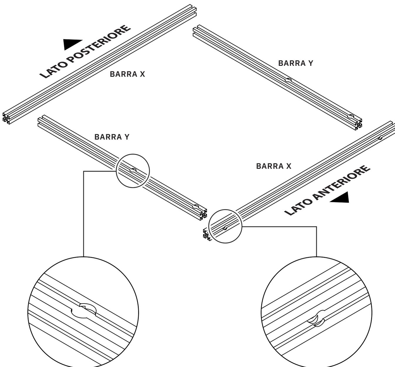
Assicurati che i due fori su ciascuna barra Y siano orientati verso il LATO ANTERIORE del gruppo del telaio di base. Verifica inoltre che le aperture rientranti di ciascun foro siano rivolte VERSO L'ALTO su entrambe le barre Y.
