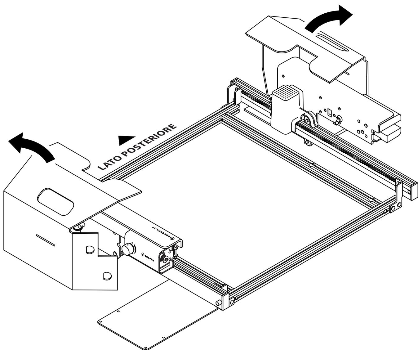
Una volta fissati i bracci sinistro e destro al gruppo del telaio di base, puoi rimuovere i supporti di montaggio in cartone. Conservali per utilizzarli in futuro oppure riciclarli.
