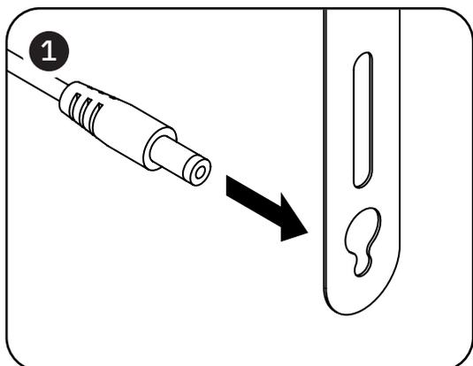
Fai passare l'estremità del cavo di alimentazione attraverso l'apertura più ampia situata all'estremità del supporto del cavo.
