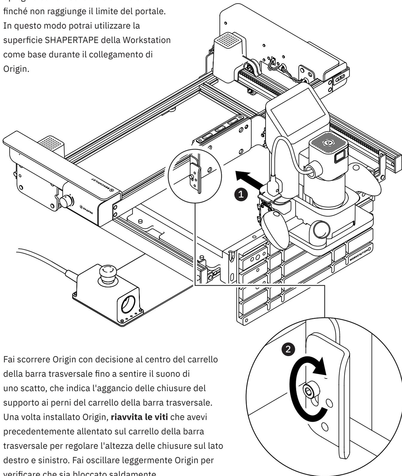
Fai scorrere Origin con decisione al centro del carrello della barra trasversale fino a sentire il suono di uno scatto, che indica l'aggancio delle chiusure del supporto ai perni del carrello della barra trasversale. Una volta installato Origin, **riavvita le viti** che avevi precedentemente allentato sul carrello della barra trasversale per regolare l'altezza delle chiusure sul lato destro e sinistro. Fai oscillare leggermente Origin per verificare che sia bloccato saldamente.
