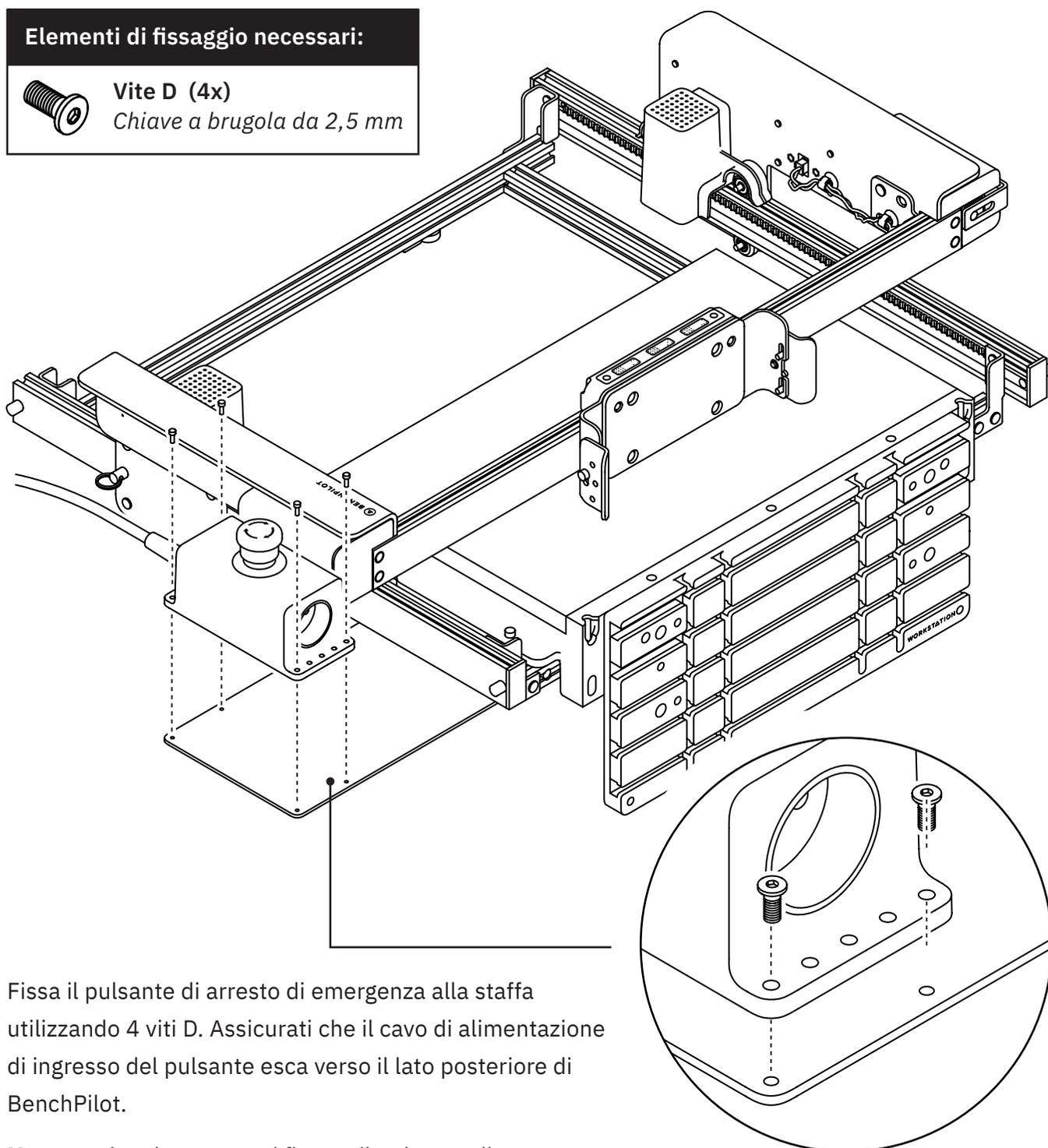
Fissa il pulsante di arresto di emergenza alla staffa utilizzando 4 viti D. Assicurati che il cavo di alimentazione di ingresso del pulsante esca verso il lato posteriore di BenchPilot.
