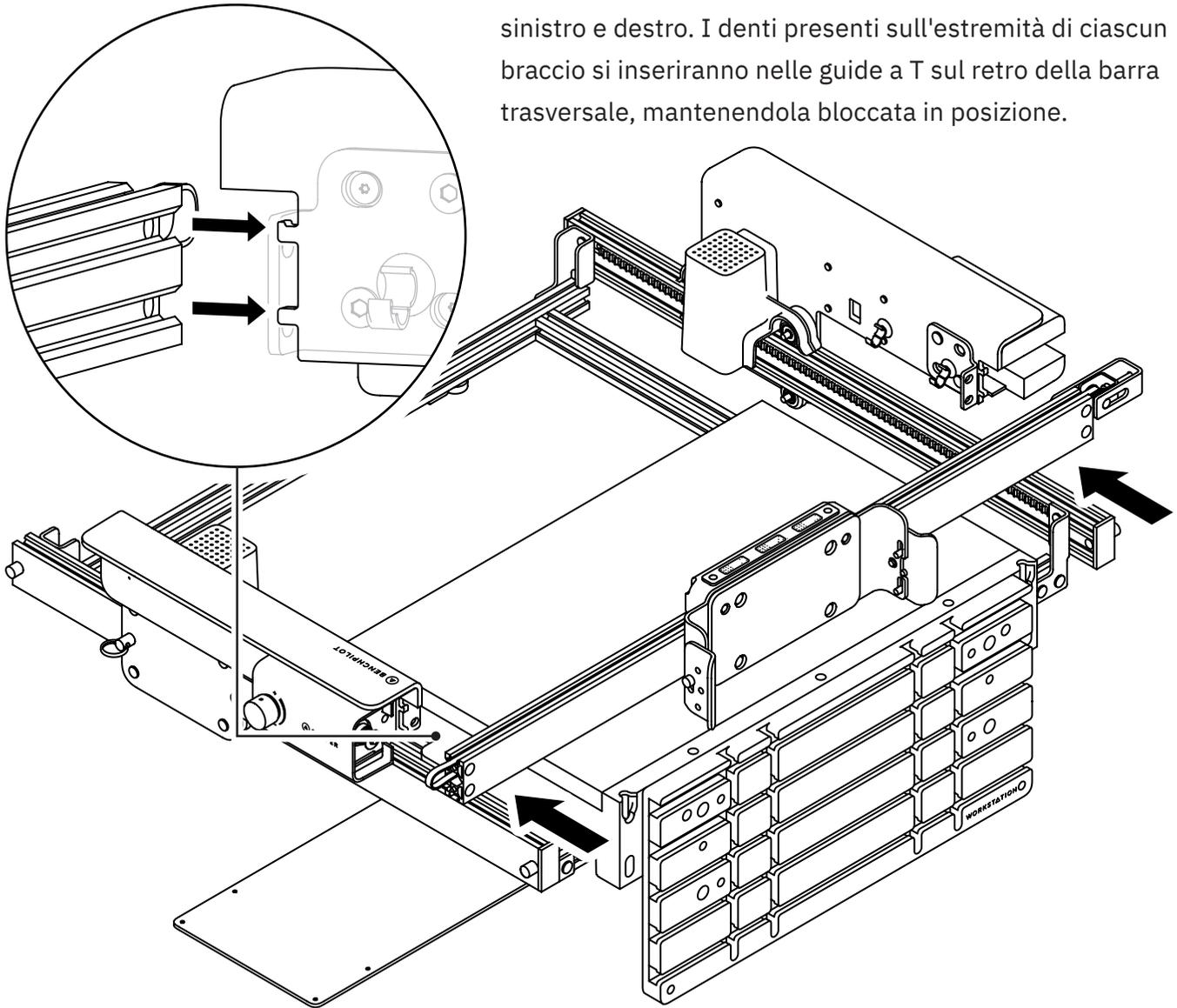
Durante l'installazione della barra trasversale, fai passare la cinghia sopra la puleggia situata sul lato anteriore del braccio sinistro. Assicurati che la cinghia passi attraverso le pulegge su entrambi i lati della barra trasversale. **Fai attenzione a non schiacciare la cinghia o i cavi presenti sul retro della barra trasversale.**
