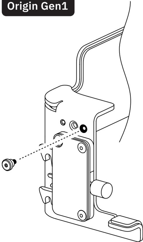
Se utilizzi **Origin Gen1** con BenchPilot, inserisci la vite E nel foro posteriore su entrambi i lati del supporto.
