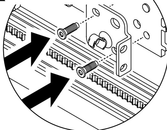
Installa le staffe della barra trasversale sui bracci sinistro e destro utilizzando 4 viti B. **NON SERRARE COMPLETAMENTE LE VITI.** Le staffe della barra trasversale devono potersi muovere leggermente. Serrerai completamente le viti in una fase successiva del processo di assemblaggio.
