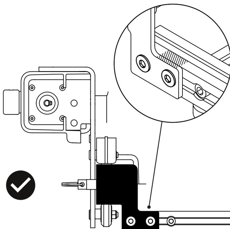
Se le staffe angolari non sono perpendicolari, sentirai un rilievo passando il dito sull'area in cui la barra X incontra la staffa angolare. Allenta le viti e ruota i bracci finché le staffe non sono correttamente allineate. In seguito serra nuovamente le viti.
