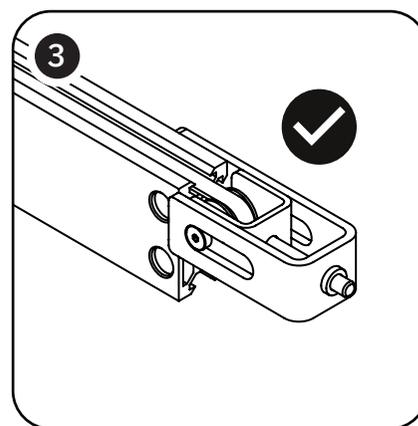
3 Allenta la vite di tensionamento finché la puleggia non raggiunge la sua posizione più a sinistra. **NON allentare oltre questo punto per evitare che la vite di tensionamento si sviti completamente.**
