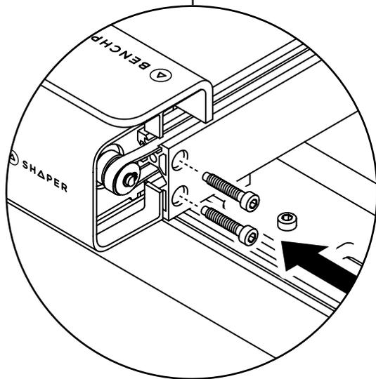
Fissa la barra trasversale ai bracci sinistro e destro inserendo 4 viti A nei fori presenti alle due estremità della barra trasversale. **Per ridurre il rischio di avvitementi incrociati**, avvia tutte le viti a mano serrandole con le dita. Una volta inserite tutte le viti, utilizza la chiave a brugola da 4 mm per serrarle completamente.
