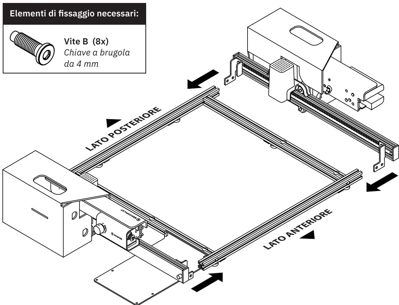
Fissa i bracci sinistro e destro al gruppo del telaio di base facendo passare 2 viti B attraverso i fori delle staffe angolari e nei fori corrispondenti delle barre X. Ripeti l'operazione per tutte e 4 le staffe angolari (8 viti). **Per ridurre il rischio di avvitiamenti incrociati**, avvia tutte le viti a mano serrandole con le dita. Una volta inserite tutte le viti, stringile con la chiave a brugola da 4 mm ma senza serrarle ancora completamente.
