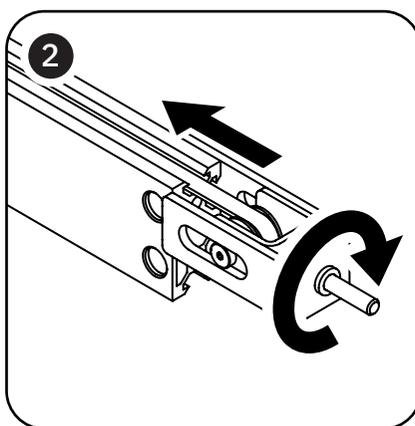
2 Usa la chiave a brugola da 2,5 mm per ruotare la vite di tensionamento **IN SENSO ORARIO** e allentare la cinghia.
