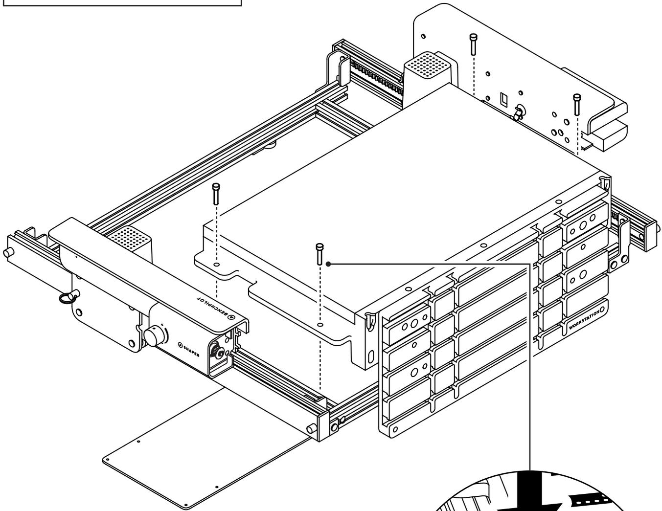
Installa Shaper Workstation allineando i fori delle relative alette di bloccaggio ai fori corrispondenti di ciascuna barra Y. Quando è posizionata correttamente sul gruppo del telaio di base, Workstation si incastra in posizione. Fissala saldamente inserendo 4 viti A nei quattro fori.
