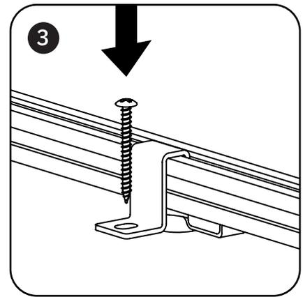
Per fissare saldamente ogni staffa di bloccaggio al banco da lavoro, utilizza dispositivi di fissaggio appropriati scelti da te.
