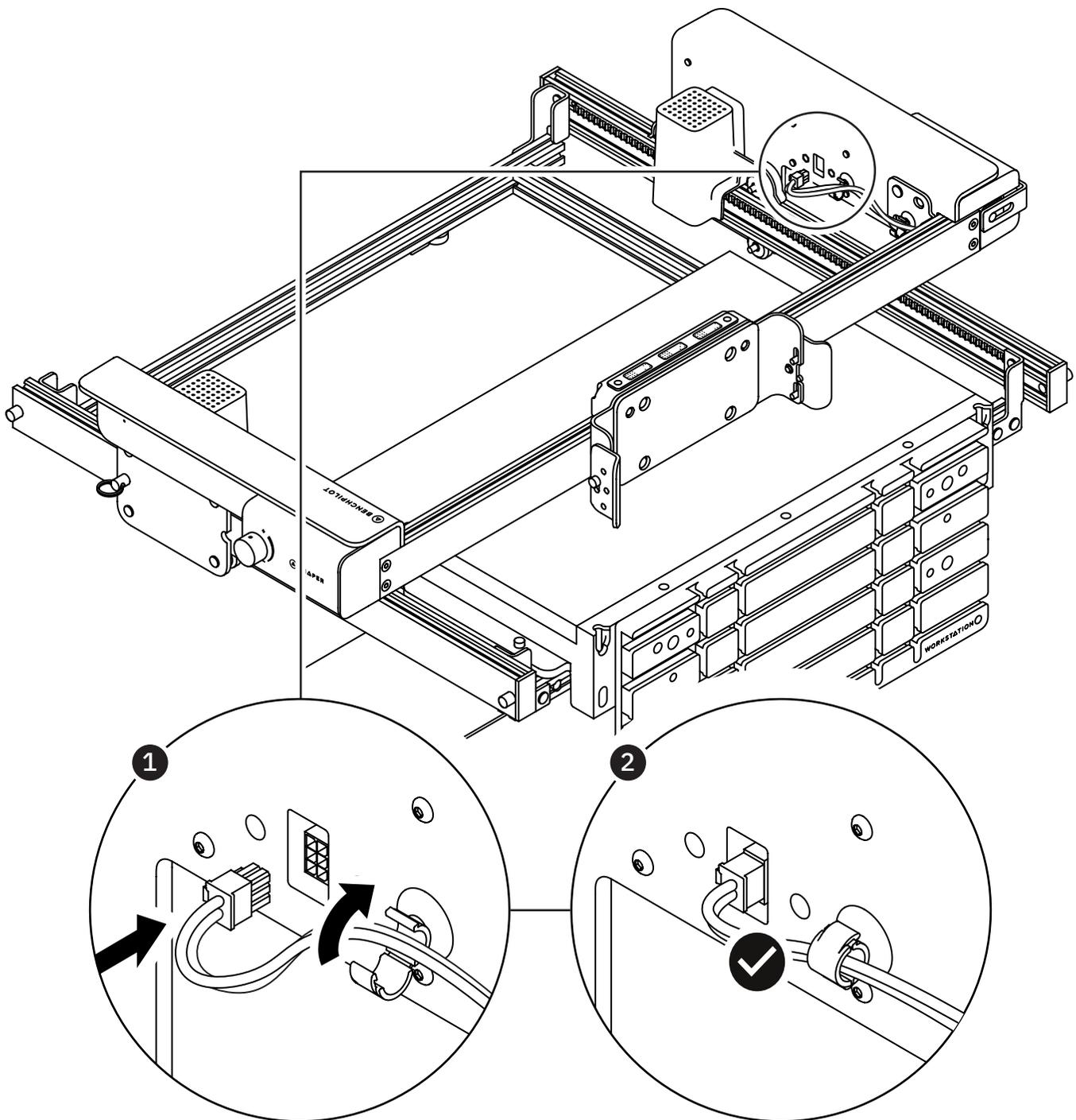
Rimuovere le fascette che tengono i cavi in posizione sul lato posteriore della barra trasversale. Fai passare i cavi attraverso i fermacavi e inseriscili nella presa del connettore all'interno dei bracci sinistro e destro. Una volta in posizione, il connettore emetterà il suono di uno scatto. Chiudi i fermacavi per fissare saldamente i cavi.
