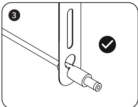
L'estremità del cavo di alimentazione dovrebbe essere fissata saldamente all'estremità del supporto del cavo.
