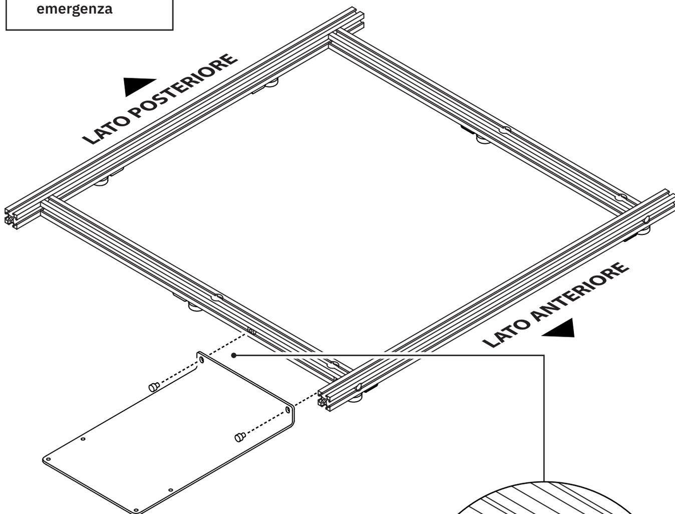
Fissa la staffa del pulsante di arresto di emergenza sul lato sinistro del gruppo del telaio di base. Allinea i dadi a T nella barra Y sinistra ai fori della staffa del pulsante di arresto di emergenza e fissala con 2 viti C. Posiziona la staffa vicino al lato anteriore del gruppo del telaio di base per garantire che il pulsante di arresto di emergenza sia facilmente raggiungibile durante l'uso di BenchPilot.
