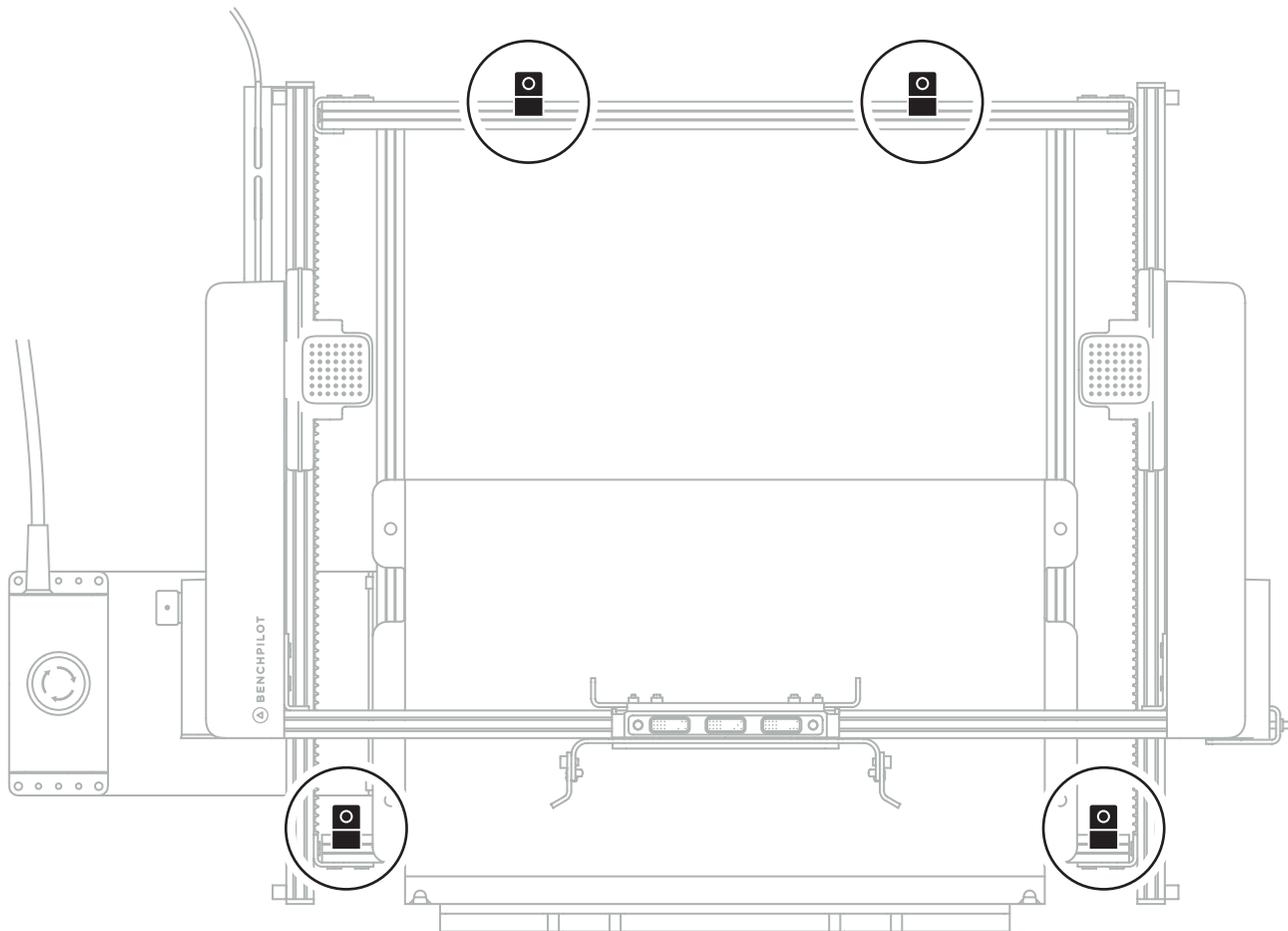
Posiziona 4x staffe di bloccaggio sulle barre X nelle posizioni indicate sopra. In alternativa puoi utilizzare dei tuoi morsetti al posto delle staffe di bloccaggio. **Assicurati che i piedini si trovino direttamente sotto ciascuna staffa di bloccaggio o sotto il punto in cui è stato applicato un morsetto.**
