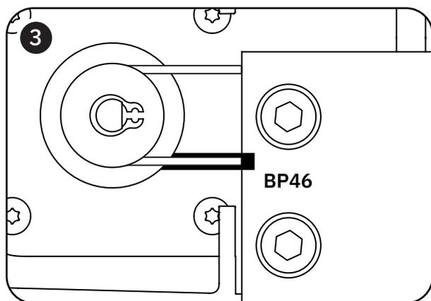
Durante il serraggio della vite di tensionamento, controlla la parte inferiore della cinghia sul lato sinistro della barra trasversale. Interrompi il serraggio quando la parte inferiore della cinghia passa attraverso il centro dei contrassegni, osservando frontalmente.
