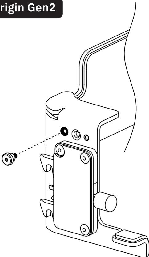
Se utilizzi **Origin Gen2** con BenchPilot, inserisci la vite E nel foro anteriore su entrambi i lati del supporto.
