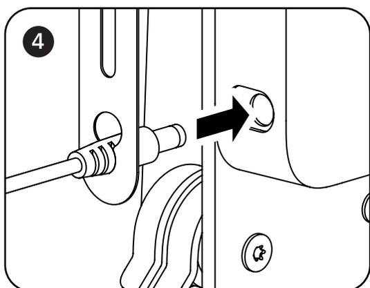
Collega l'estremità del cavo di alimentazione al connettore di alimentazione situato sul retro del braccio sinistro.
