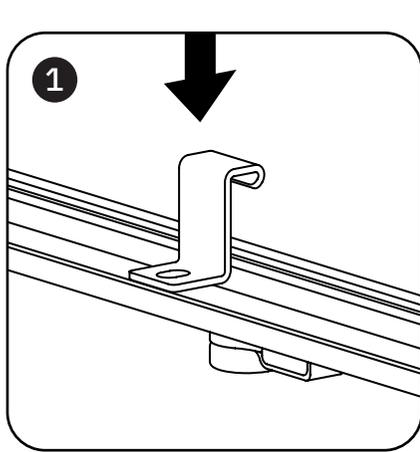
Inserisci ogni staffa di bloccaggio sulle barre a X in modo che si agganci alla guida a T.
