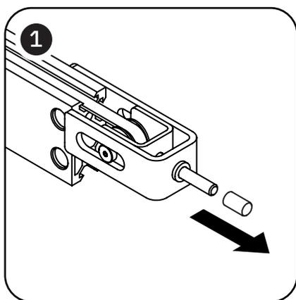
1 Rimuovi il cappuccio protettivo dall'estremità della vite di tensionamento. Conservalo con cura, verrà reinstallato dopo il tensionamento della cinghia.
