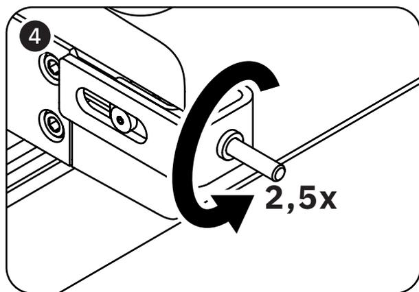
Una volta che la parte inferiore della cinghia è centrata rispetto ai contrassegni, usa la chiave a brugola da 2,5 mm per ruotare la vite di tensionamento di 2,5 giri aggiuntivi. In questo modo imposterai la tensione corretta - **NON SERRARE ECCESSIVAMENTE**. Reinstalla il cappuccio protettivo che hai rimosso nel passaggio 10.1.
