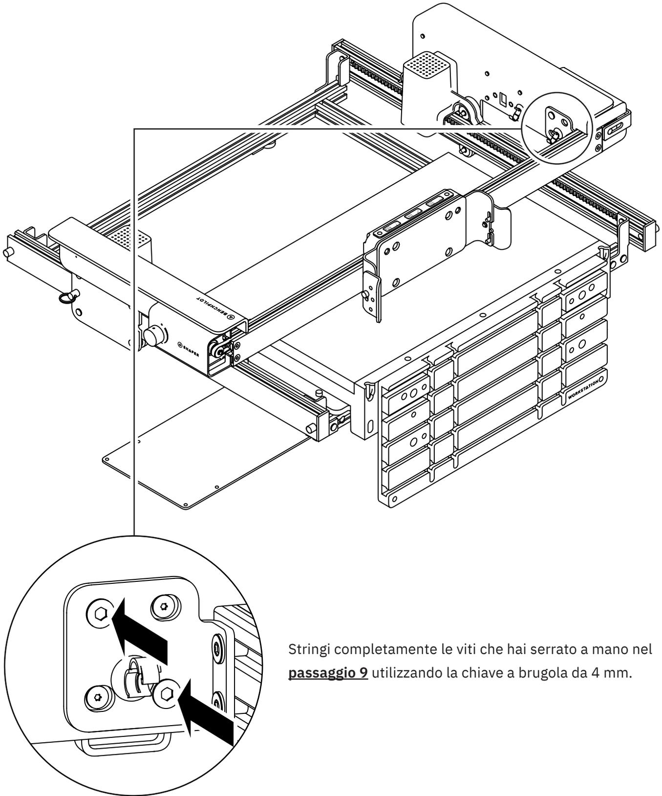
Stringi completamente le viti che hai serrato a mano nel **passaggio 9** utilizzando la chiave a brugola da 4 mm.
