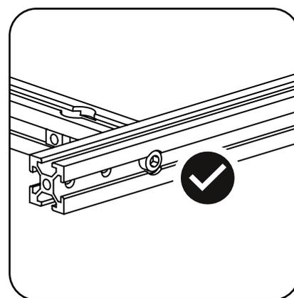
Assicurati che tutte le viti siano a filo o al di sotto della superficie esterna delle barre X, all'interno delle aperture rientranti.
