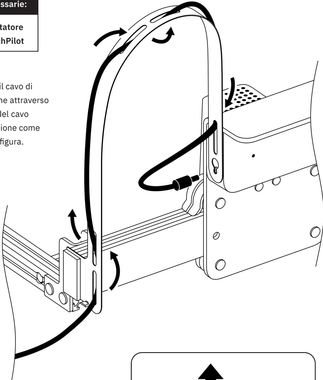
Allarga ciascun passaggio per il cavo spingendo ogni lato in direzioni opposte. Questa operazione ti permetterà di inserire l'estremità del cavo attraverso l'apertura.
