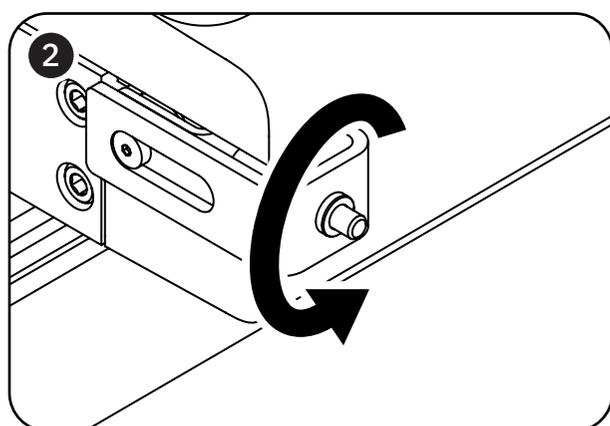
Usa la chiave a brugola da 2,5 mm per ruotare la vite di tensionamento IN SENSO ANTIORARIO e aumentare la tensione della cinghia.
