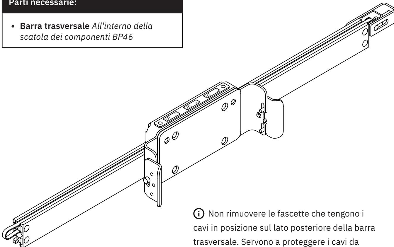
**i** Non rimuovere le fascette che tengono i cavi in posizione sul lato posteriore della barra trasversale. Servono a proteggere i cavi da schiacciamenti durante le successive fasi di montaggio e verranno rimosse in seguito.
