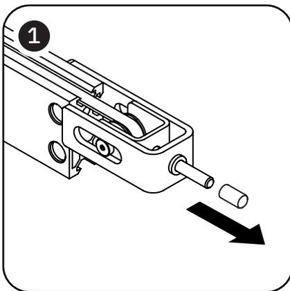
Ziehe die Schutzkappe vom Ende der Spannschraube ab. Bewahre sie sicher auf, sie wird nach dem Spannen des Riemens wieder angebracht.
