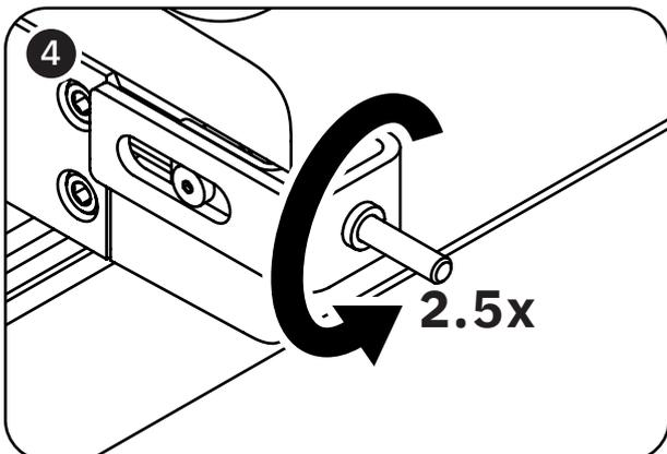
Sobald die Unterseite des Riemens entlang der Markierungen zentriert ist, verwende den 2,5-mm-Inbusschlüssel, um die Spannschraube um weitere 2,5 Umdrehungen zu drehen. Dadurch wird der Riemen auf die richtige Spannung eingestellt - **NICHT ÜBERSPANNEN**. Bringe die Schutzkappe, die du in Schritt 10.1 entfernt hast, wieder an.
