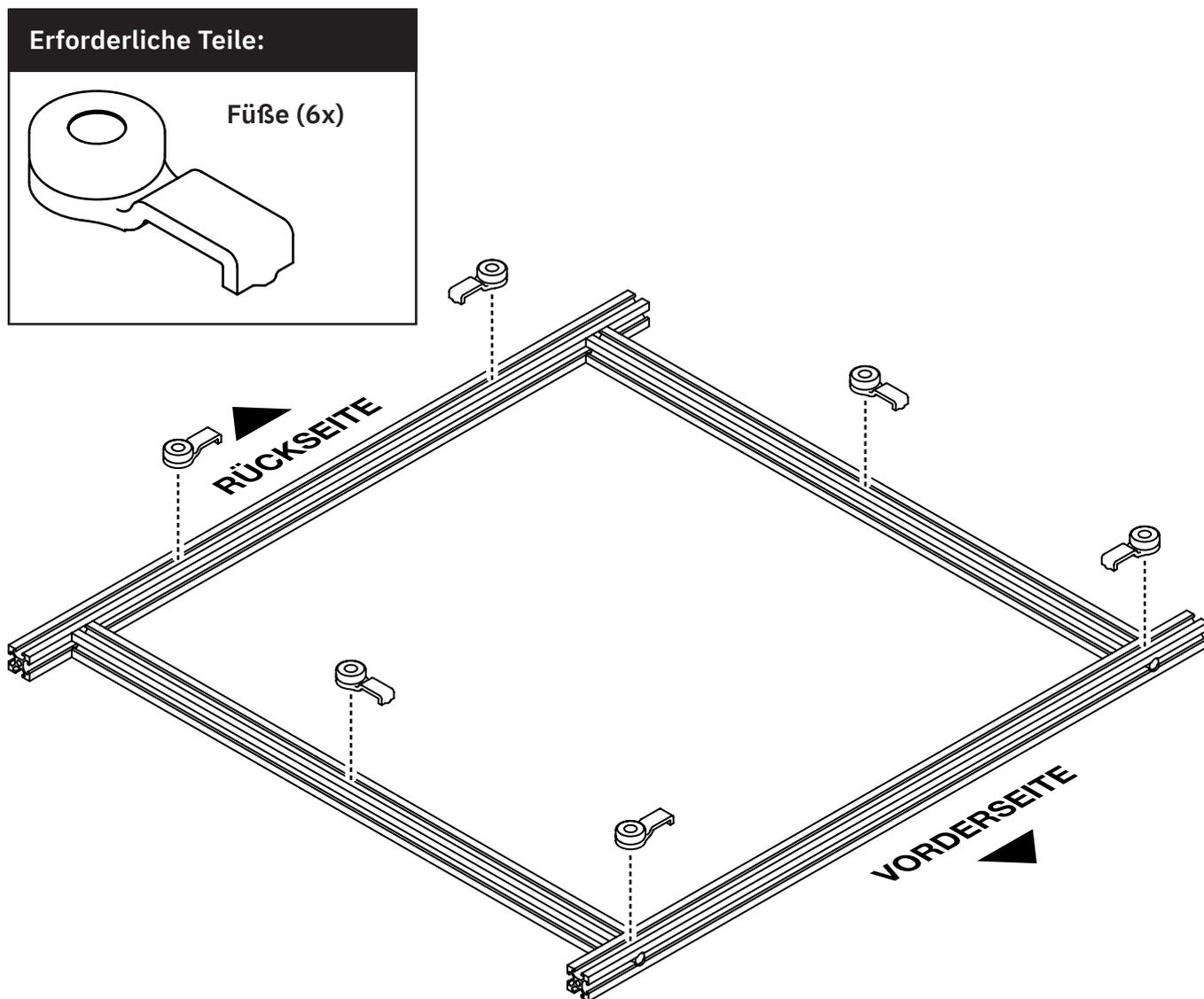
Bringe die FüÙe an, indem du sie in die T-Nuten auf der Unterseite der X- und Y-Leisten schiebst. Drehe sie um 90 Grad, um sie zu fixieren.
