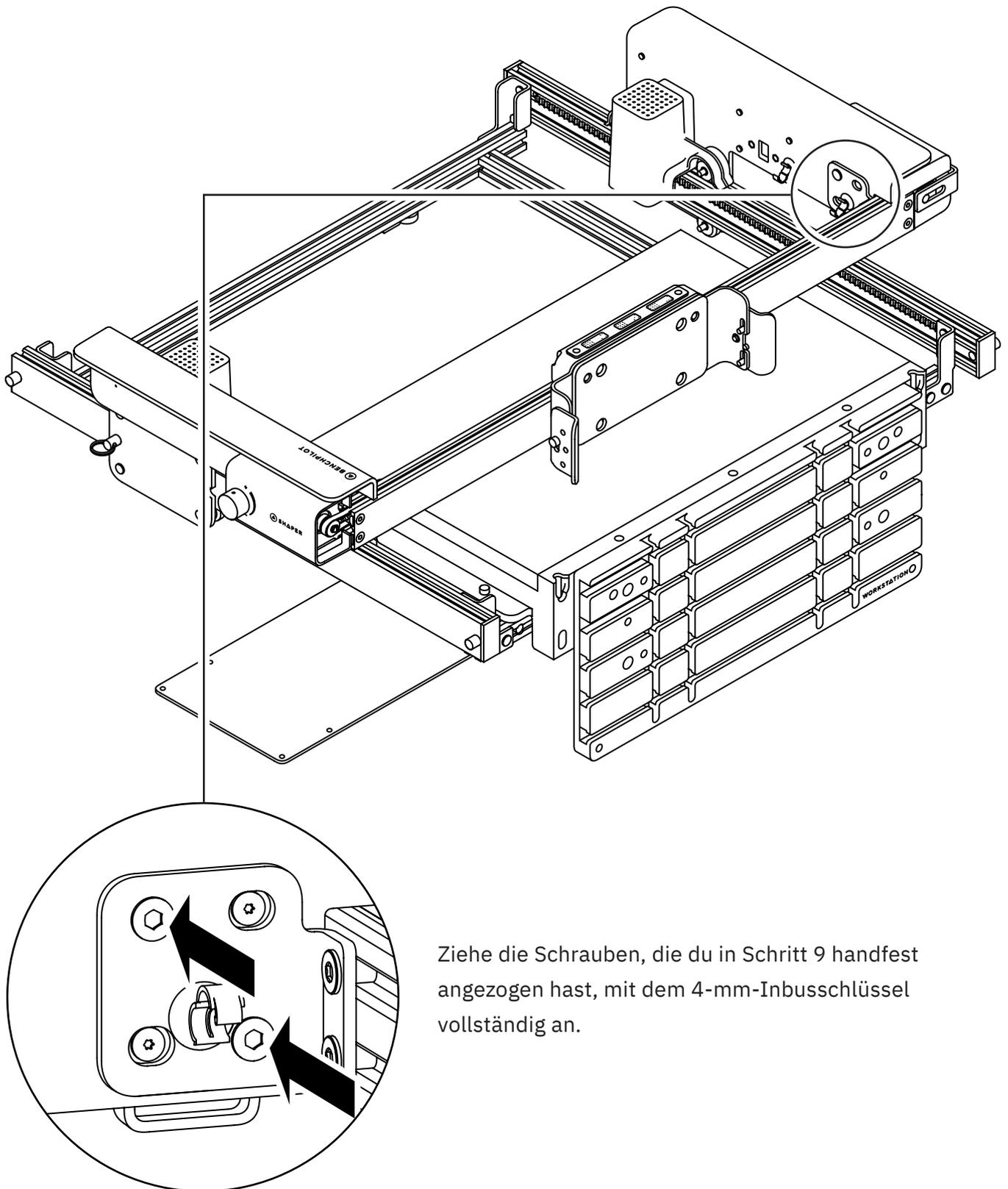
Ziehe die Schrauben, die du in Schritt 9 handfest angezogen hast, mit dem 4-mm-Inbusschlüssel vollständig an.
