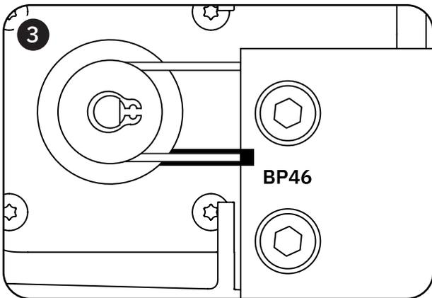
Beobachte beim Anziehen der Spannschraube die Unterseite des Riemens auf der linken Seite der Querstange. Höre auf zu spannen, wenn die Unterseite des Riemens bei frontaler Betrachtung durch die Mitte der Markierungen verläuft.
