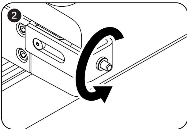
Verwende den 2,5-mm-Inbusschlüssel, um die Spannschraube GEGEN DEN UHRZEIGERSINN zu drehen und den Riemen zu spannen.
