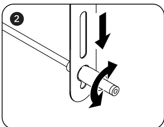
Drehe das Ende des Stromkabels hin und her, während du es nach UNTEN drückst, um das Ende des Stromkabels in die kleinere Öffnung zu stecken.
