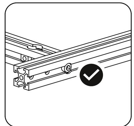
Achte darauf, dass alle Schrauben bündig oder tiefer als die Oberfläche der X-Leisten sitzen.
