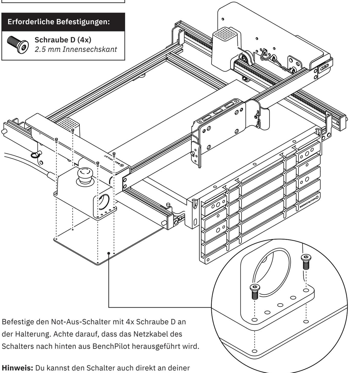
Befestige den Not-Aus-Schalter mit 4x Schraube D an der Halterung. Achte darauf, dass das Netzkabel des Schalters nach hinten aus BenchPilot herausgeführt wird.
