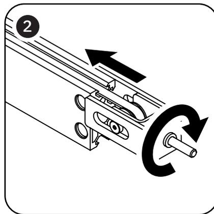
Verwende den 2,5-mm-Inbusschlüssel, um die Spannschraube im Uhrzeigersinn zu drehen. Dadurch wird der Riemen gelockert.
