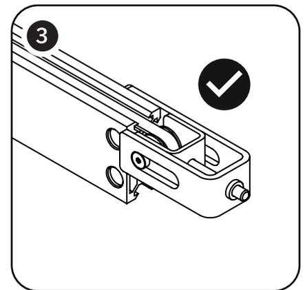
Löse die Spannschraube, bis sich die Riemenscheibe so weit links wie möglich befindet. **Löse die Schraube NICHT über diesen Punkt hinaus, damit die Spannschraube herausfällt.**
