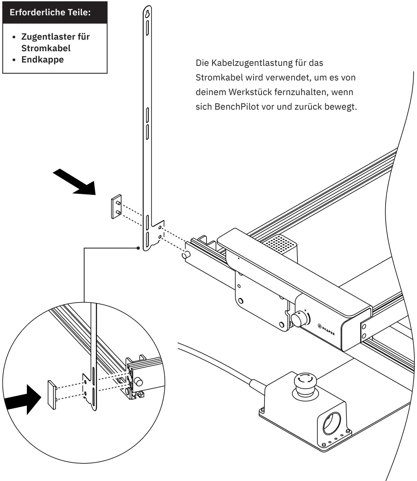
Installiere die Kabelzugentlastung für das Stromkabel, indem du sie zwischen dem linken Arm und der dazugehörigen Endkappe einklemmst. Drücke die Endkappe fest auf das Ende des linken Arms, um die Kabelzugentlastung zu fixieren.
