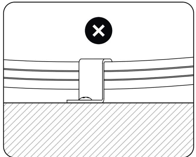
**RAHMEN NICHT VERBIEGEN** - stelle sicher, dass sich die Füße direkt unter jedem Haltebügel oder jeder Zwinge befinden.
