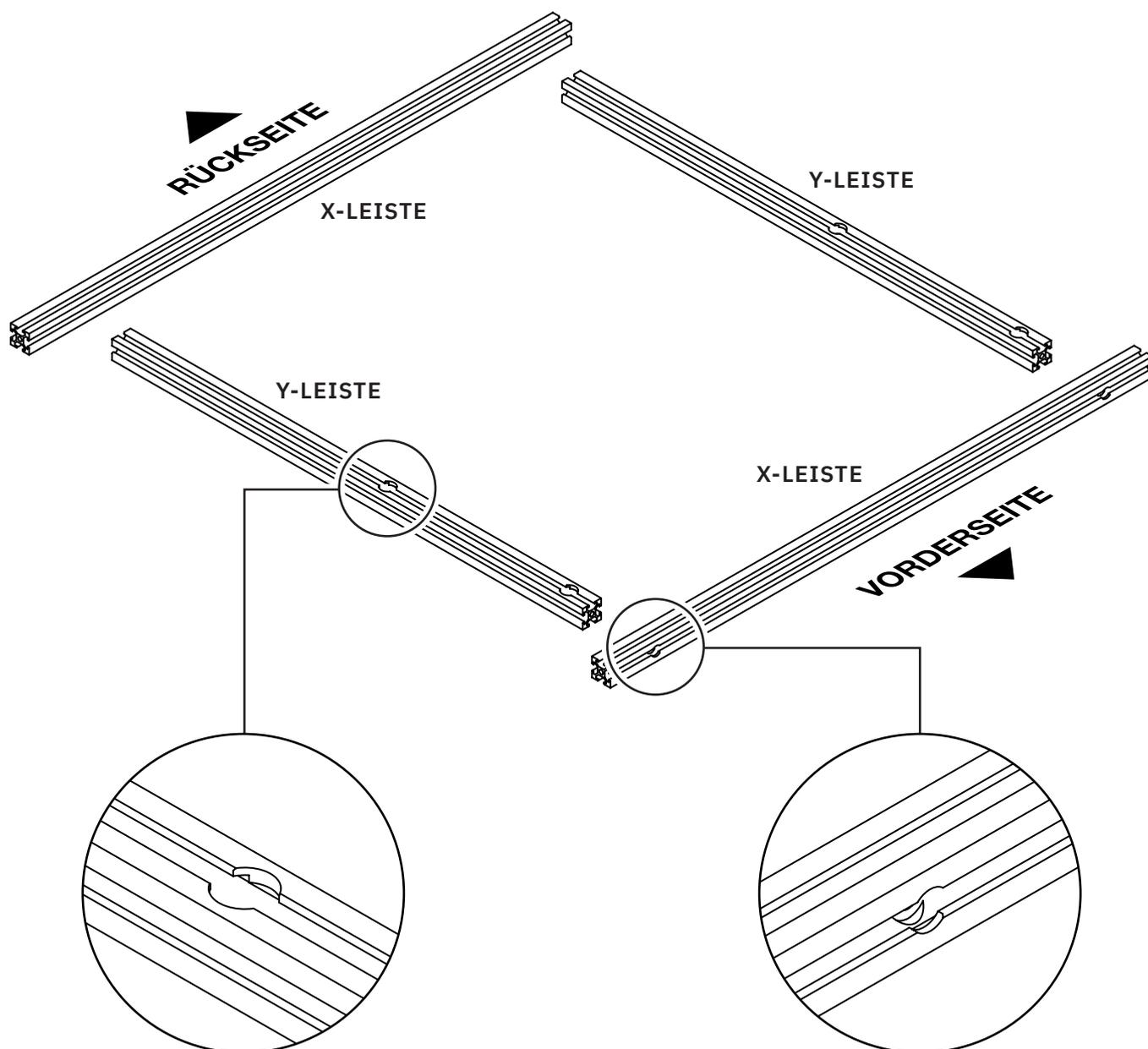
Achte darauf, dass die beiden Löcher an den Y-Leisten zur VORDERSEITE des Rahmens ausgerichtet sind und dass die Öffnungen an jedem Loch an beiden Y-Leisten nach OBEN zeigen.
